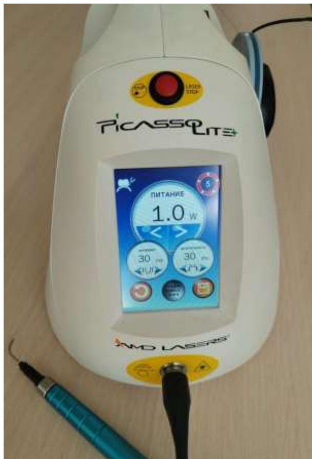
Рис. 15. Picasso Lite – стоматологический диодный лазер со сменным оптоволоконном (фото из архива кафедры)
