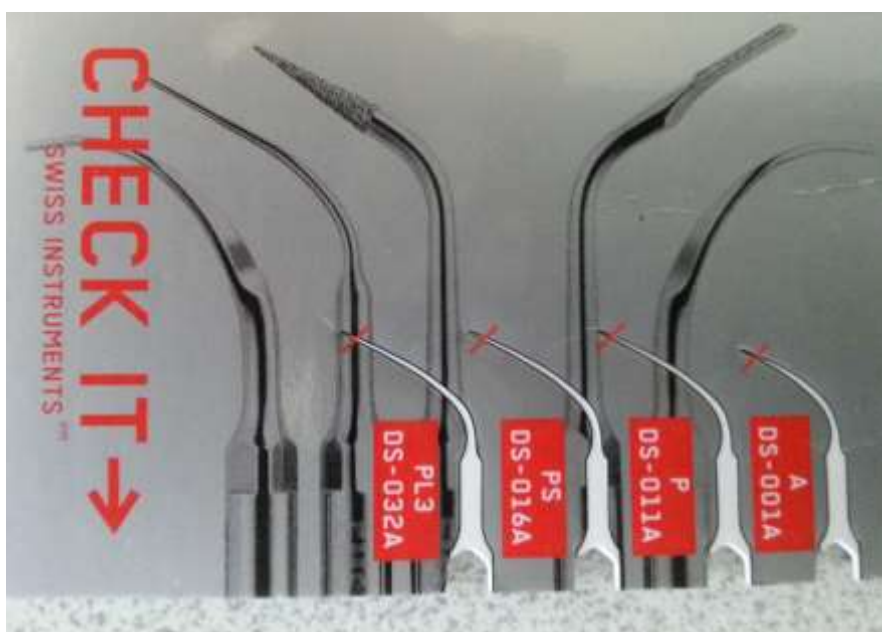
Рис. 7. Шаблон для контроля износа ультразвуковых насадок к аппарату Piezon Master 600 (фото из архива кафедры)
