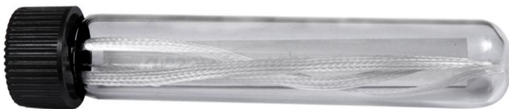
Рис. 8. Арматура на основе неорганической матрицы (стекловолокна) GlasSpan («GlasSpan», США) (фото из архива кафедры)
